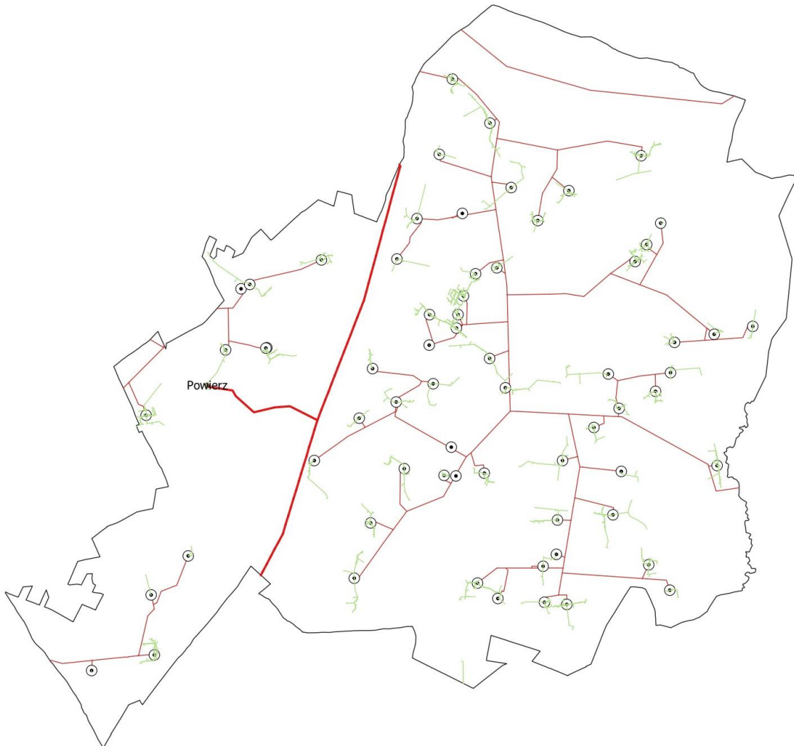
Rysunek 3. Schemat infrastruktury elektroenergetycznej na terenie gminy wraz z planowaną lokalizacją GPZ i linii 110 kV
